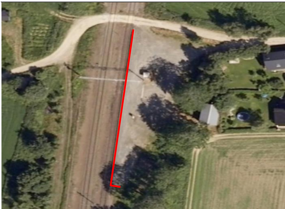
Eksempel på registrering av Jernbaneplattformkant (rød strek).
