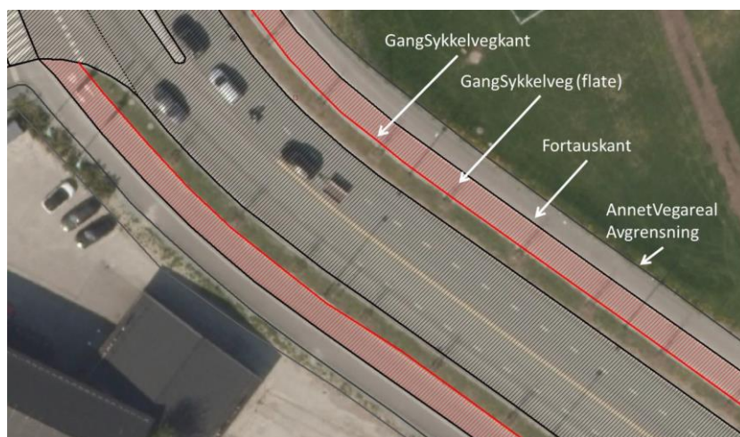
Eksempel på registrering av GangSykkelveg langs fortau.
